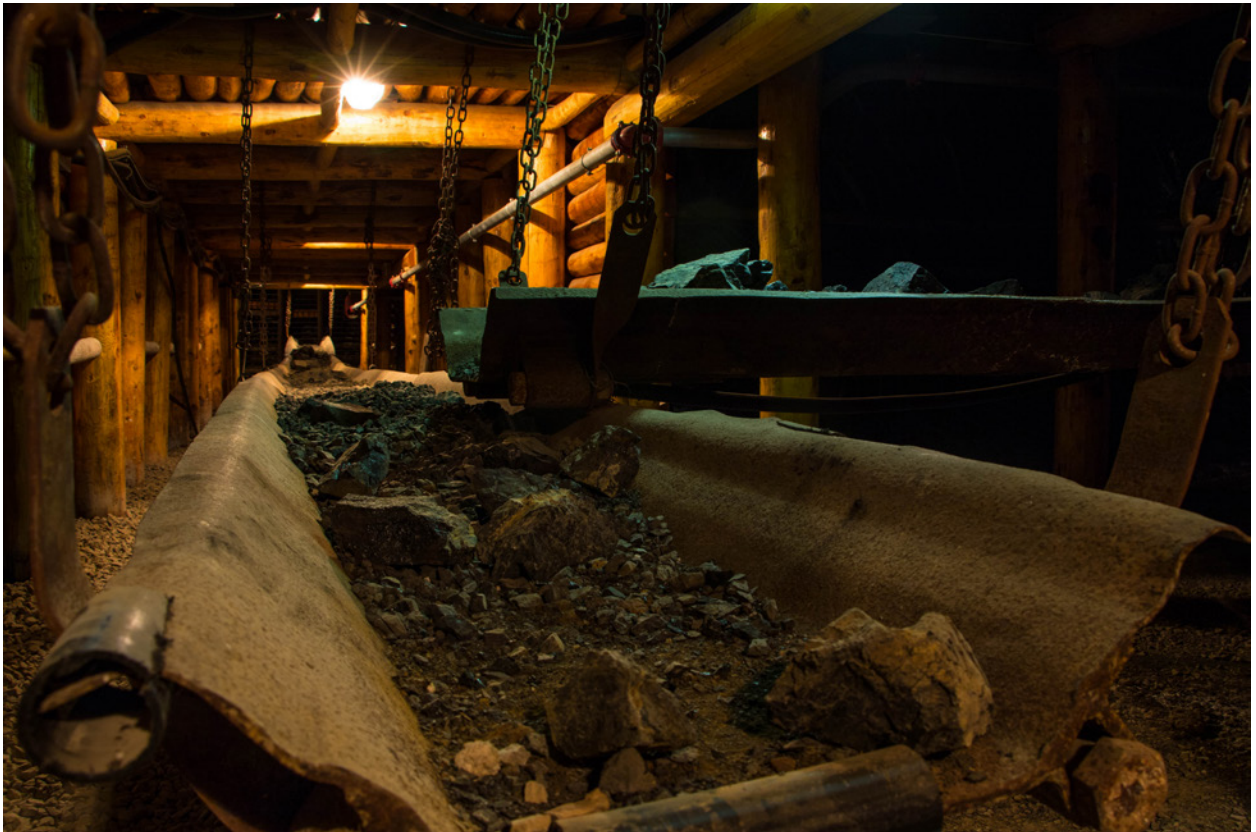
Fig. 2. Galleria sotterranea, armature a quadro e tavole oscillanti (Foto di Claudia Locci, Archivio Centro Italiano della Cultura del Carbone).
